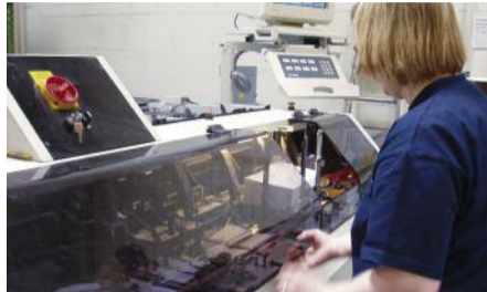
Seite 2 – OMR-/Barcode gesteuerte Kuvertiermaschine bringt höchste Flexibilität...
